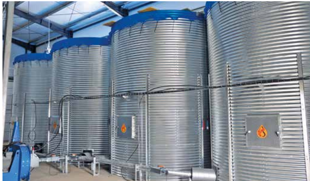
Silo rond HIMEL & broyeur avec aspiration et refoulement
