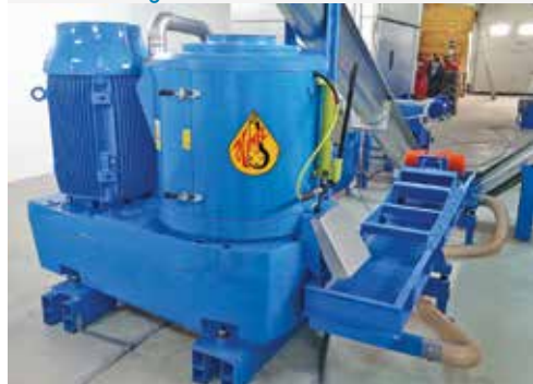
Presse à granulés avec filière plate pour tiges longues
