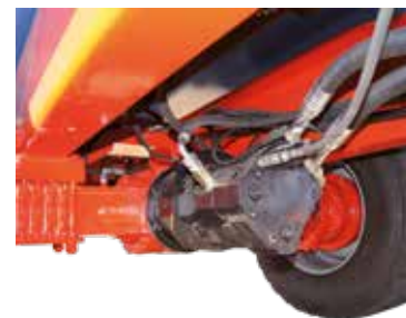
Essieu moteur avec blocage du différentiel.
