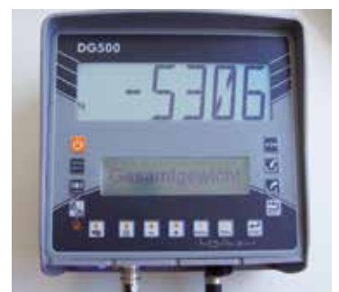
Automate de pesage avec transfert de données
