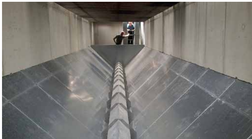
Fosse bétonnée avec convoyeur
