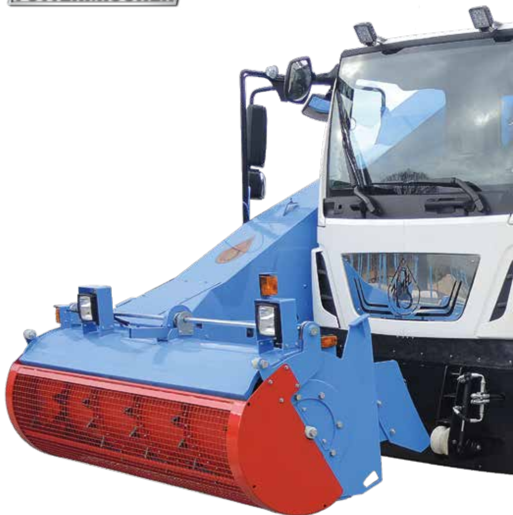
Automotrice SF140S avec fraise et système de mélange à 3 vis
