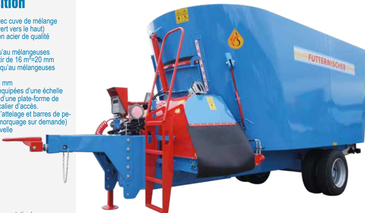
Mélangeuse VV18 avec équipement spécial tapis à chaîne à l'avant et roues jumelées
