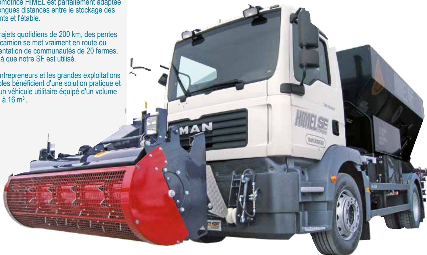
Mélangeuse SF160 avec fraise à haut rendement
