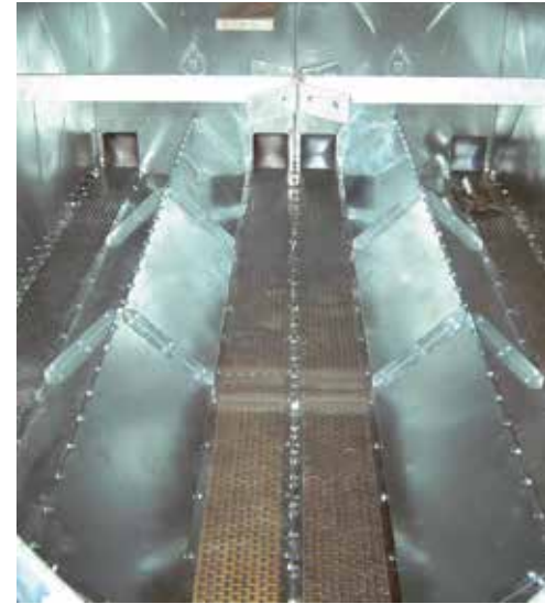
Silo de stockage rectangulaire avec plancher ventilé et vidange pneumatique
