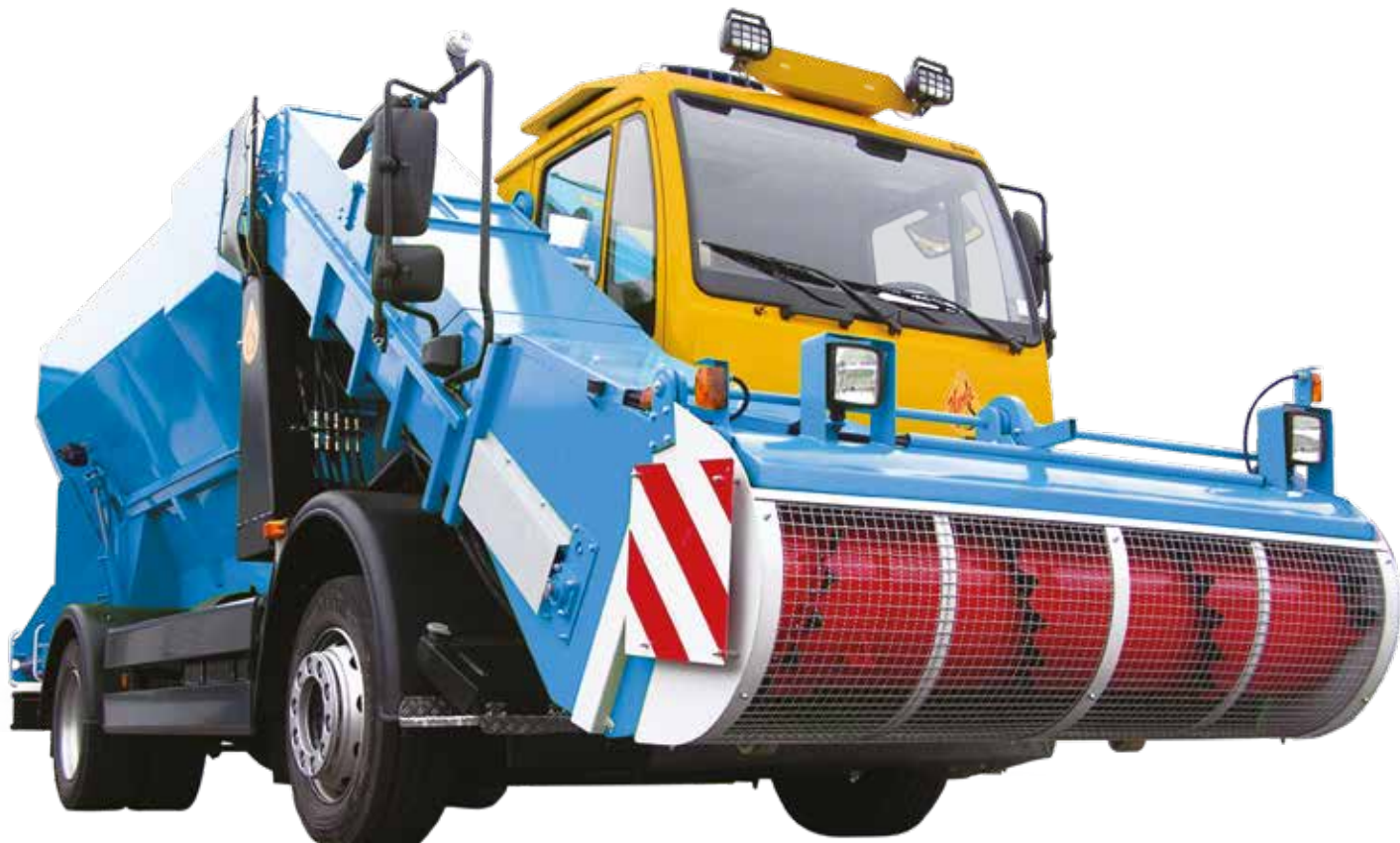
Automotrice SF120 avec fraise et système de mélange à 3 vis
