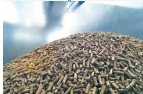
Refroidissement des granulés dans le silo d'aération
