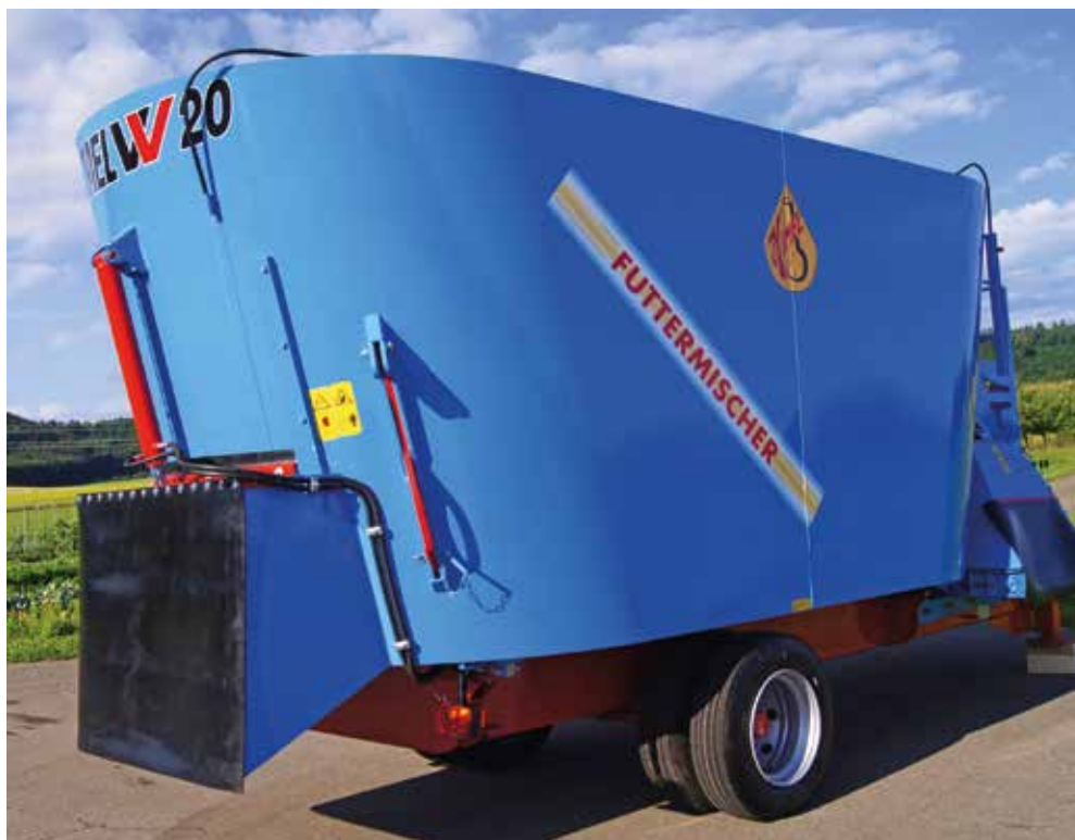
Mélangeuse VV20 avec déchargement supplémentaire à l'arrière
