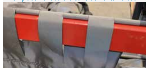
Réparation à l'aide de boucles divisées
