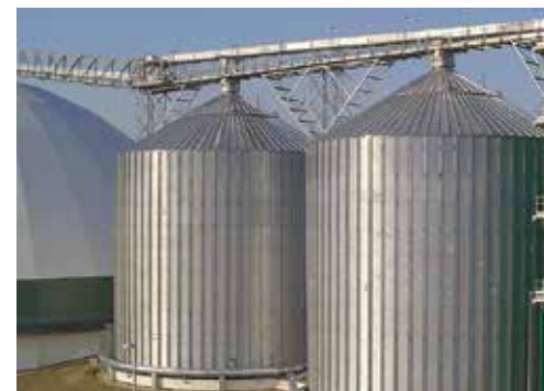
Installation de silos extérieurs avec passerelles et ventilation du grain
