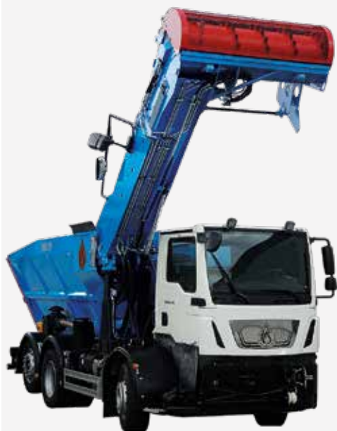
Automotrice SF140S avec fraise et système de mélange à 3 vis
