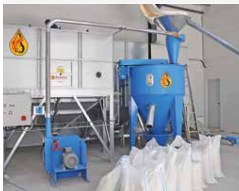
Mélangeur d'aliments HIMEL & broyeur avec aspiration et refoulement
