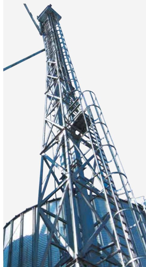
Usine avec élévateur à godets de 39m de haut.
