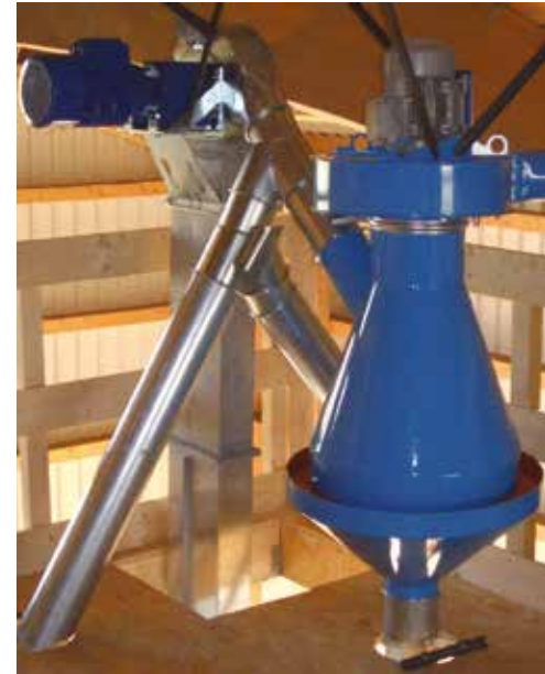
Élévateur à chaîne et pré-nettoyeur HIMEL
