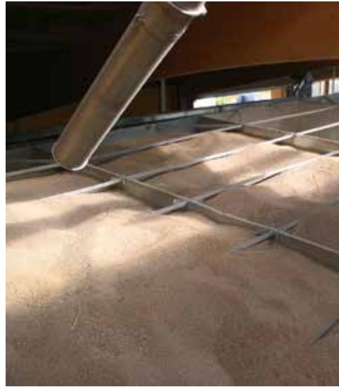
Silo de stockage rectangulaire, cellules remplies
