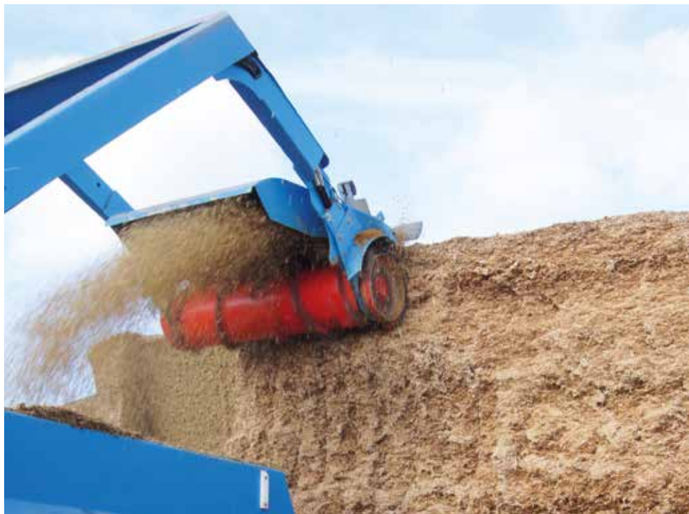
La fraise à haute performance avec descente automatique
