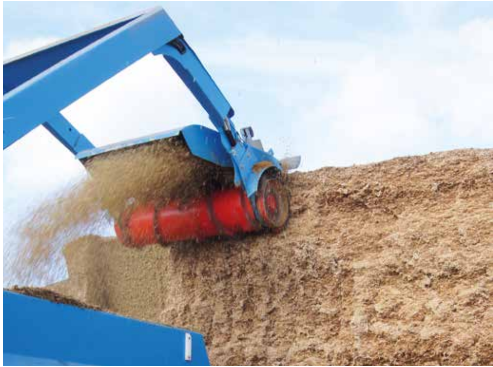
Die freischneidende Hochleistungsfräse mit Absenkautomatik
