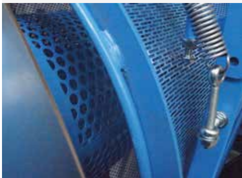
HTR mit 2 Siebtrommeln
