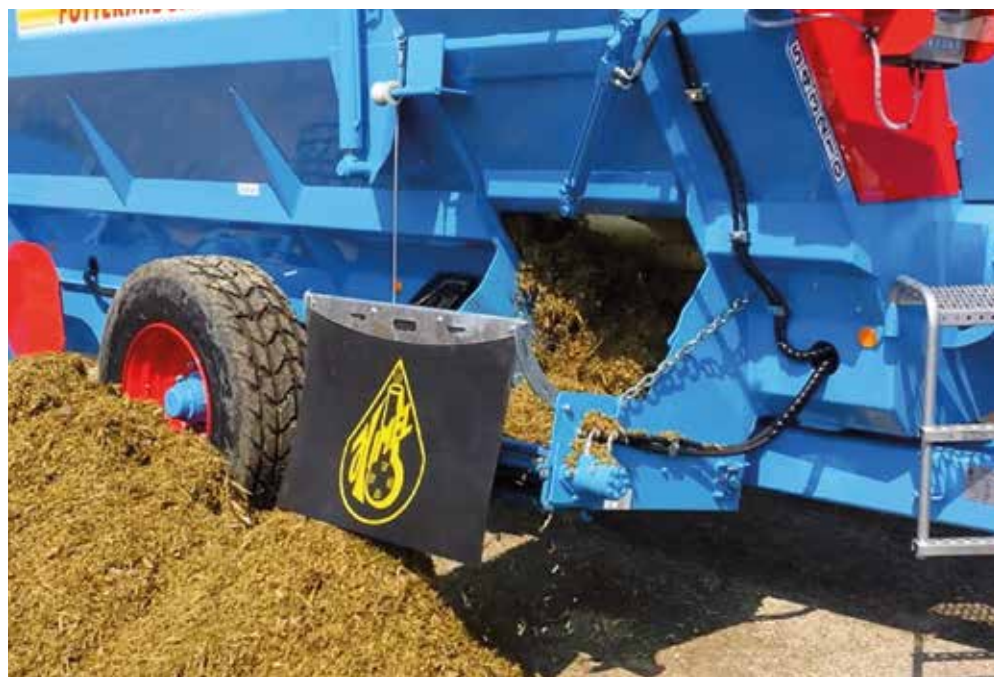
HIMEL HX108 mit Standardaustragung vorne rechts
