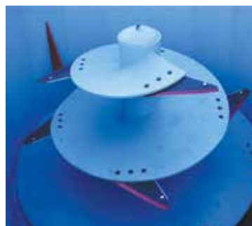
Mischerschnecke V (einfach)
