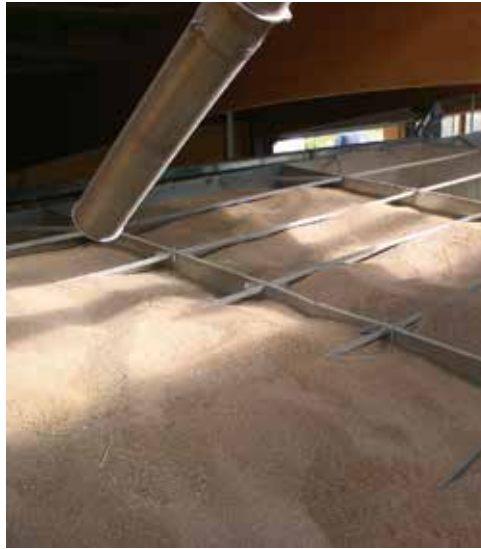
Rechteck-Lagersilo Silozellen befüllt
