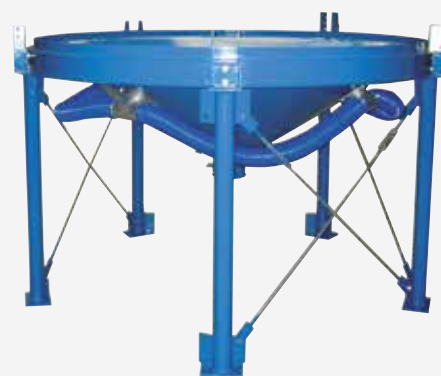
Trichterunterbau mit I-Füßen und Belüftung
