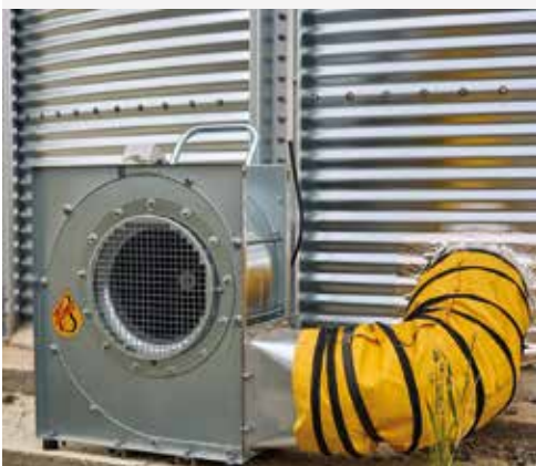
Belüftungsgebläse TLR an einem Außensilo
