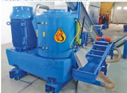
Pellet­pres­se mit Flachmat­ri­ze für Halmgüter
