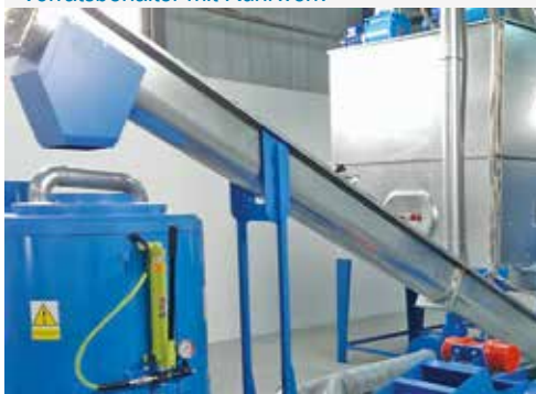
Dosier- und Konditionierschnecke
