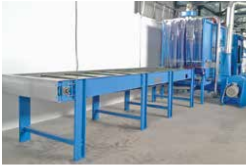
Ballenauflöser mit Vorlagetisch
