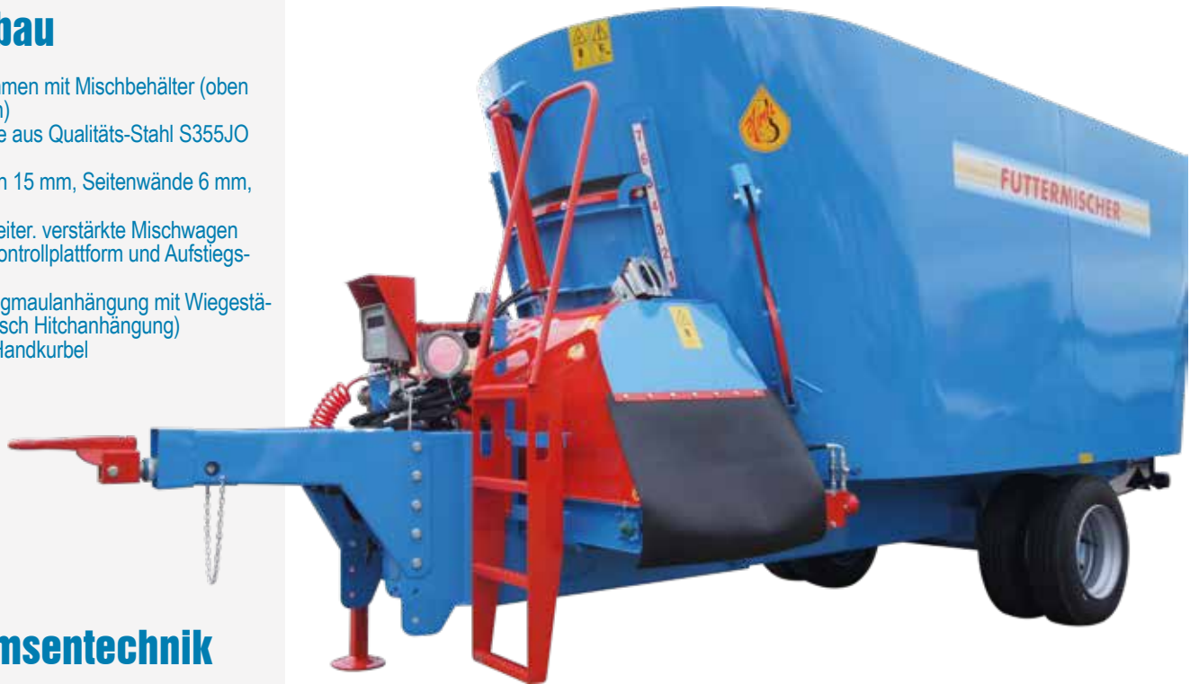
Futtermischwagen VV18 mit Sonderausstattung Kettenband vorne und Zwillingsbereifung
