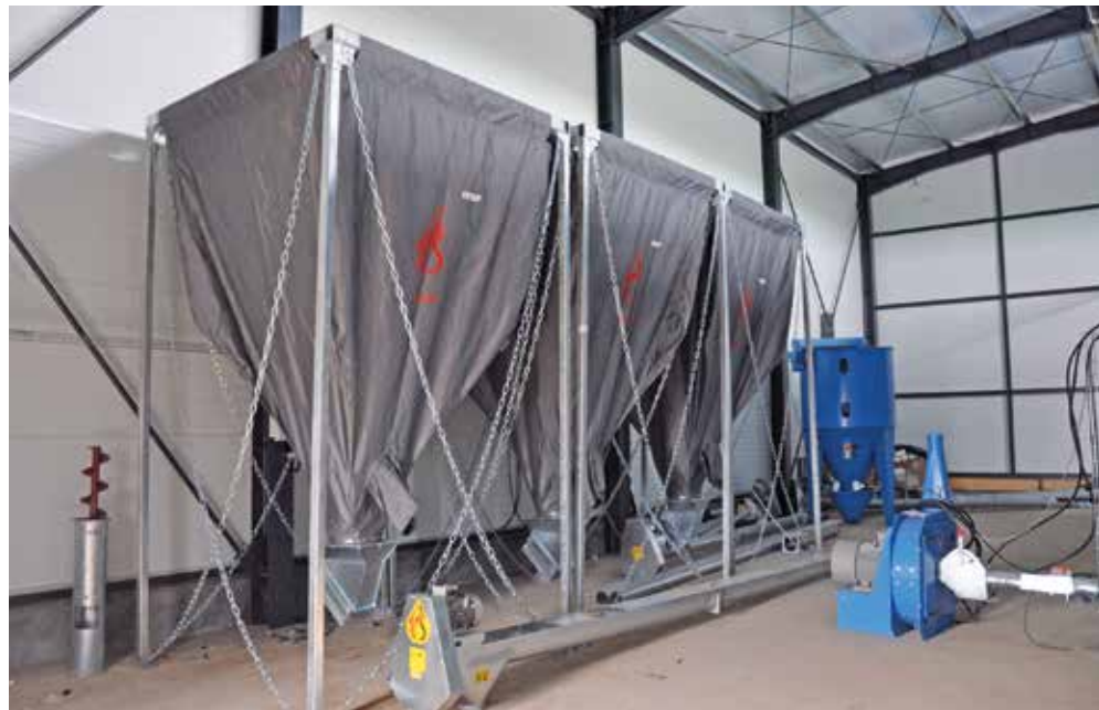
HIMEL UV Stoffsilos mit Futtermischer und Gebläsemühle
