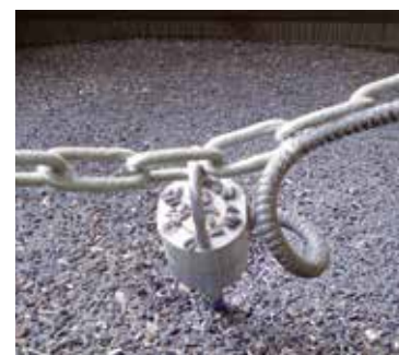
Messgehänge im Silo
