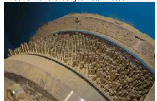
Gepresste Pellets in der Matrize
