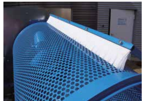
Bürste zur Reinigung der Siebtrommel
