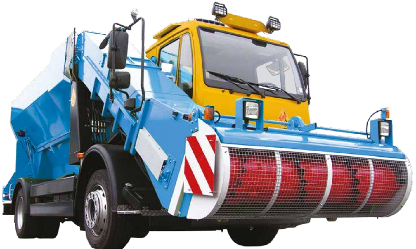
Selbstfahrer SF120 mit Fräse und 3 Schnecken Mischsystem
