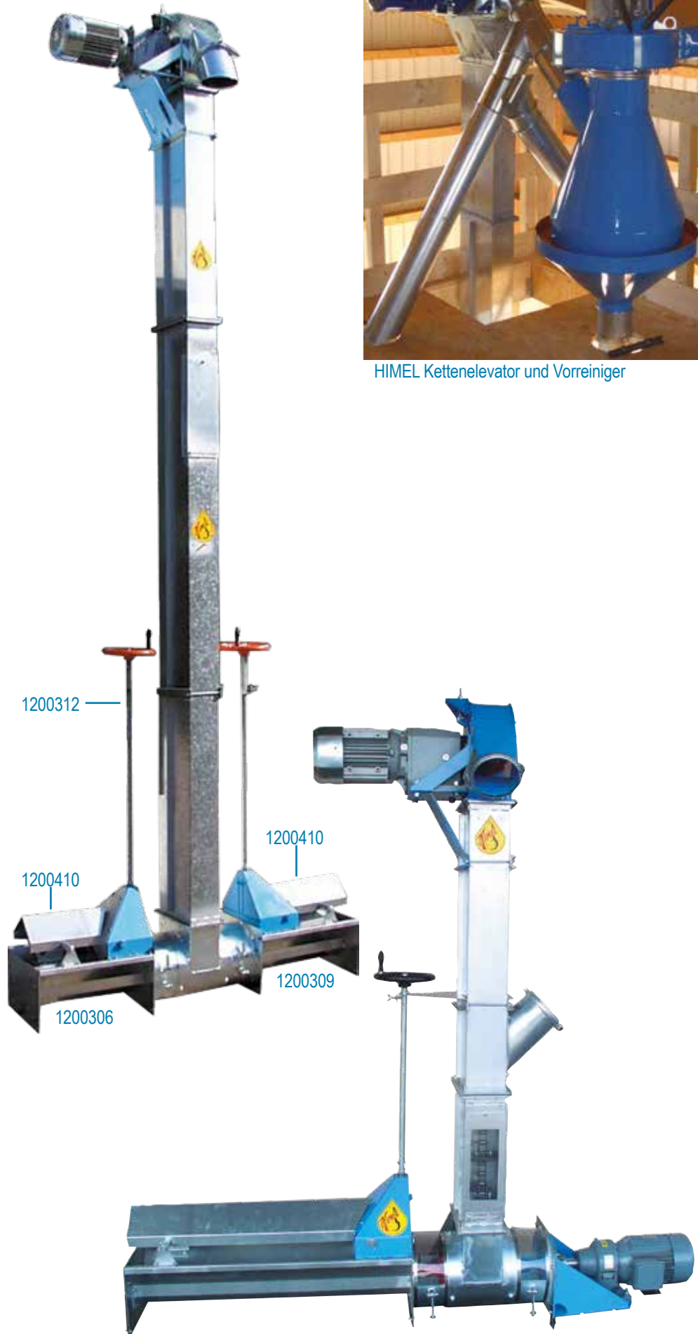
Kettenelevator K30, Antriebsstation in Förderrichtung links und Zubringerförderrinne rechts angebaut
