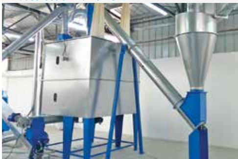
Vorratsbehälter mit Rührwerk
