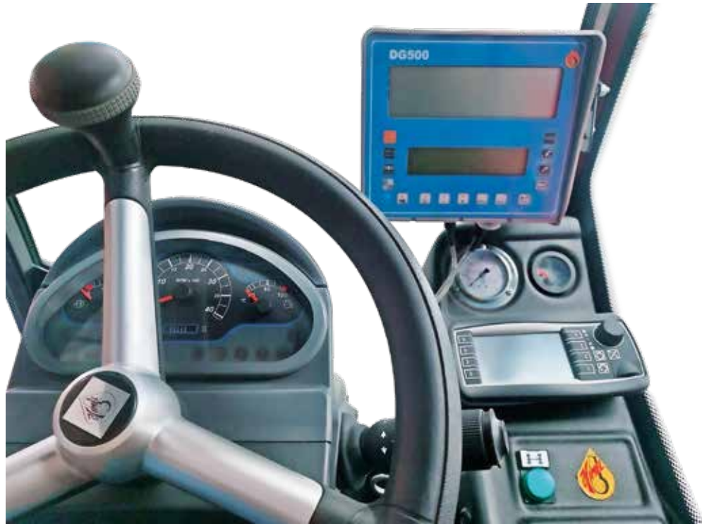
HIMEL Wiegecomputer DG500 in einem Selbstfahrer SFV16
