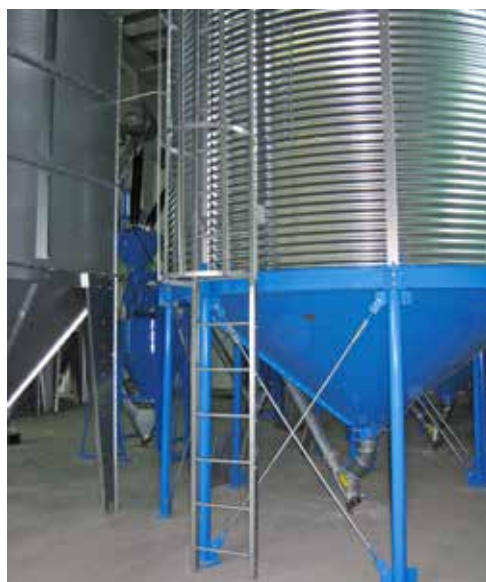
Rundsilo mit Trichterunterbau
