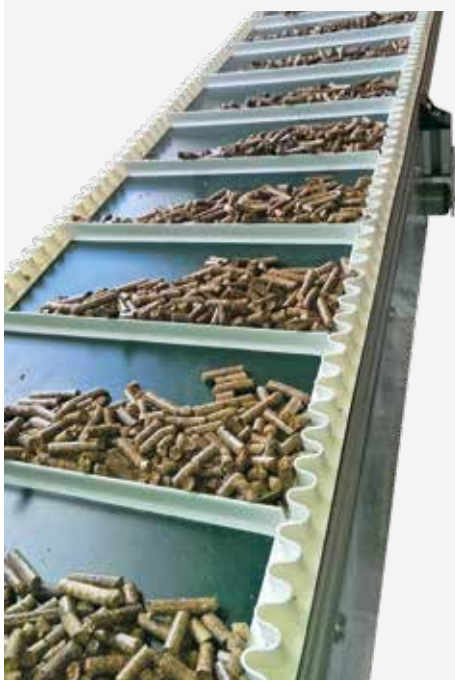
Übergabeband mit Pellets
