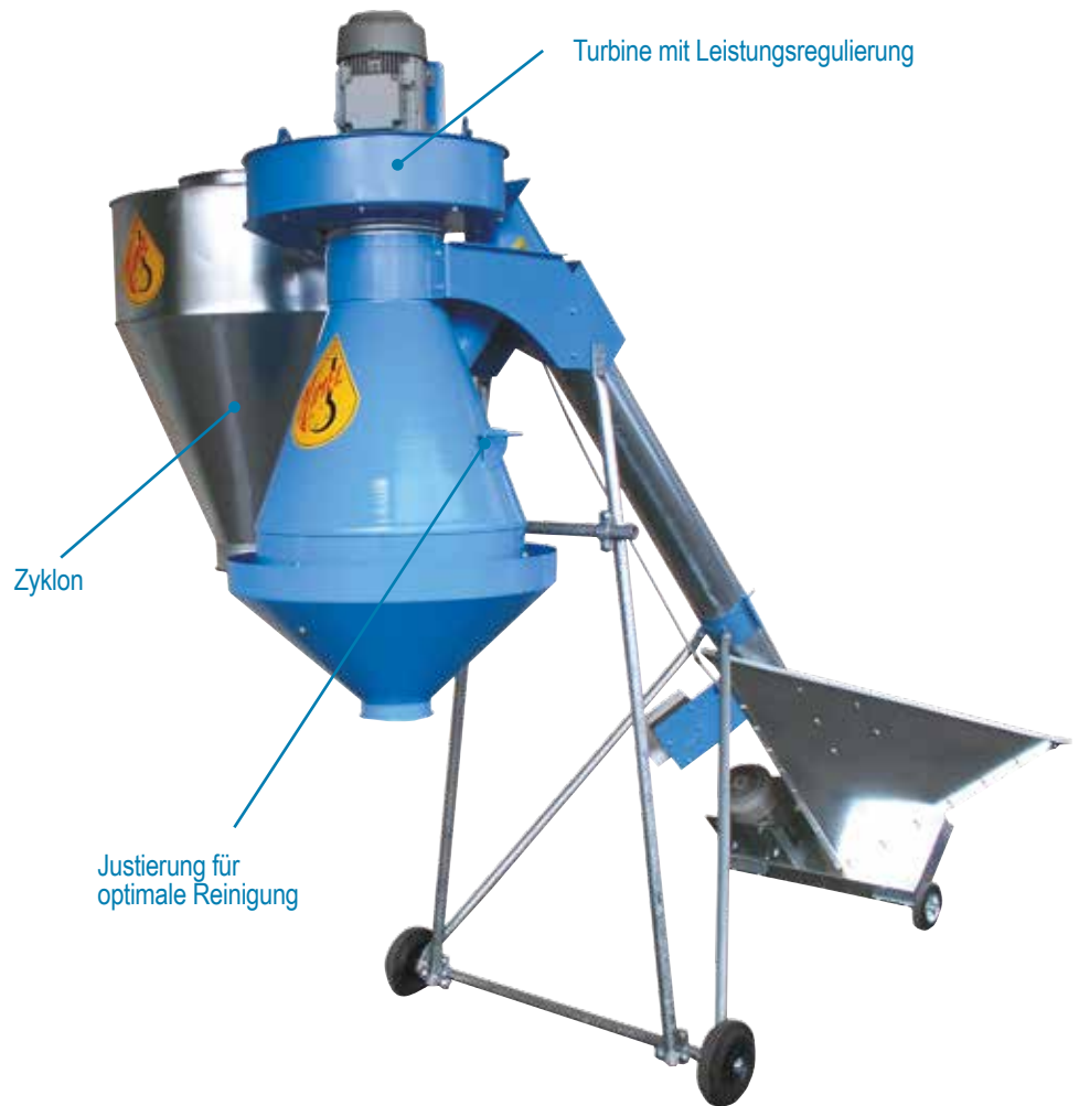
Mobile Abbladestation Ø152 mit Vorreiniger V25
