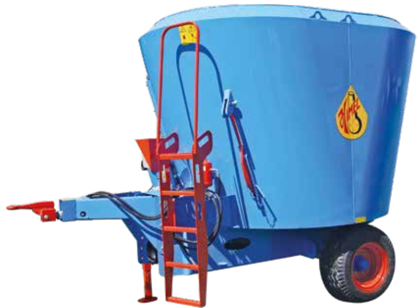
Futtermischwagen V7-18 mit Aufstiegsleiter
