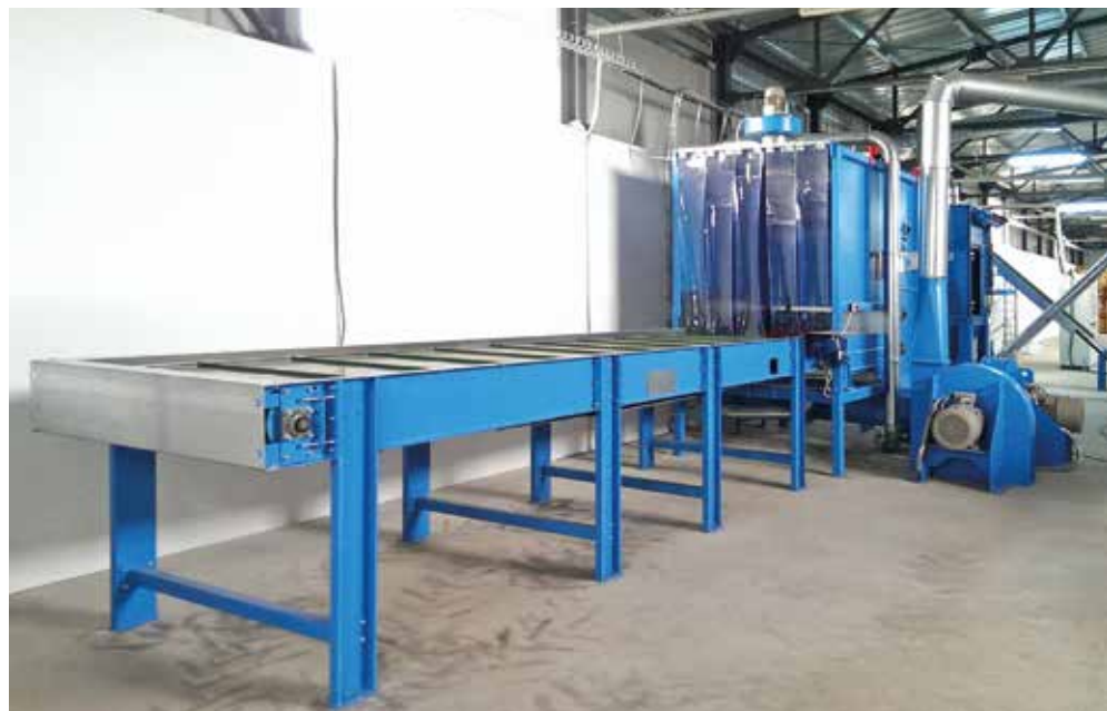
Ballenauflöser stationär mit Vorlegetisch
