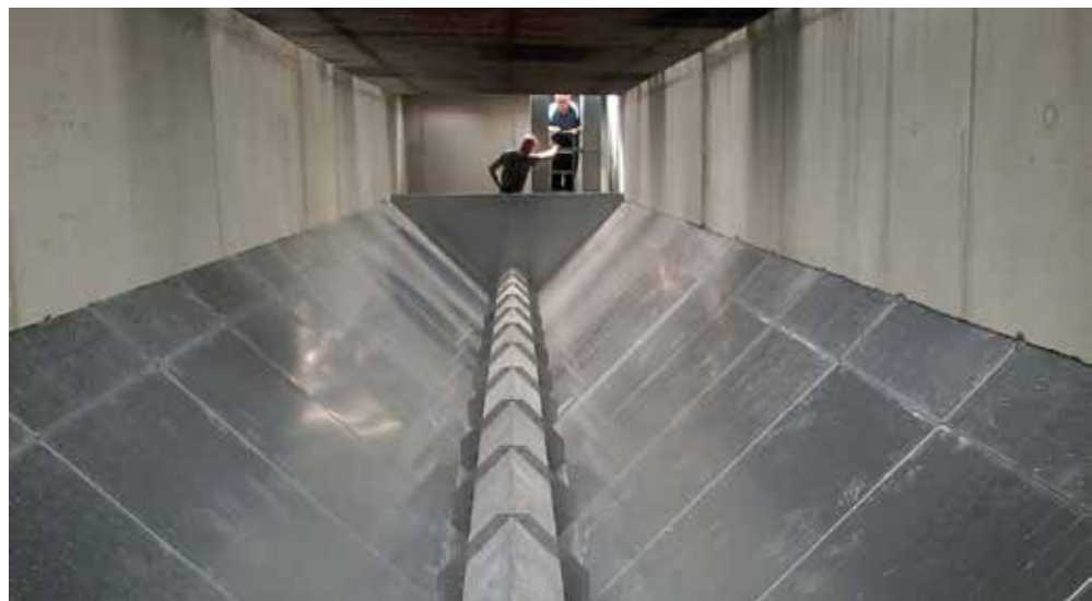
Betonierte Schüttgutannahme mit Gossenredler
