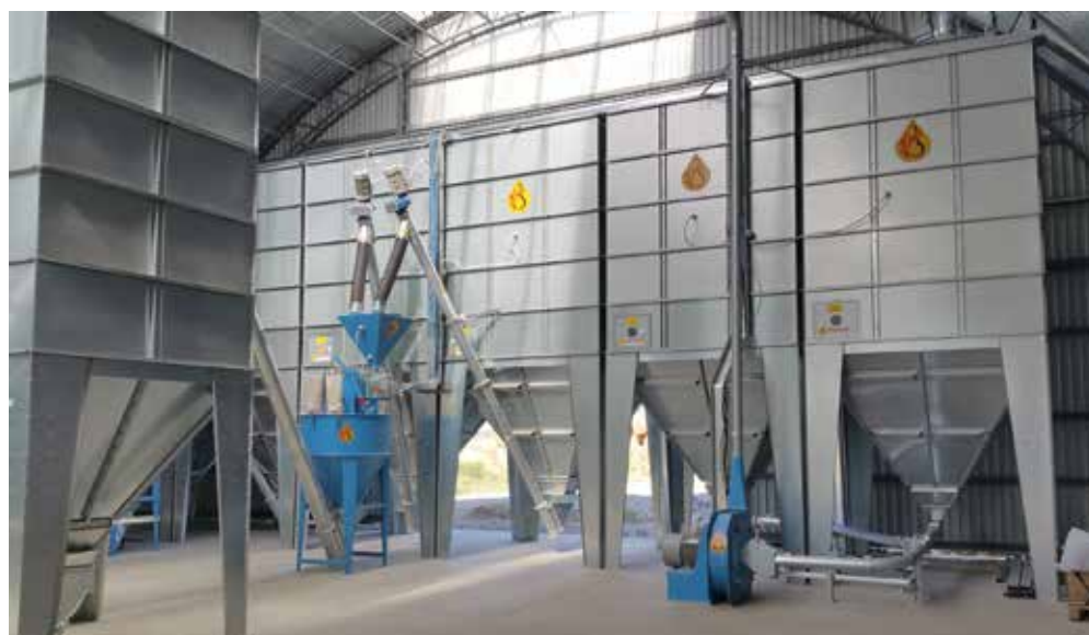
Mahl- Mischanlage mit Modusilo 60° als Komponentensilos
