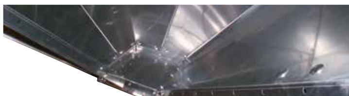
Innenansicht Auslauftrichter mit Schieber
