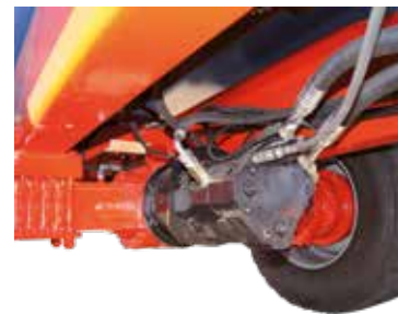
Achsantrieb mit Differentialsperre
