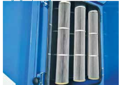
Filtereinheit mit Patronenfilter
