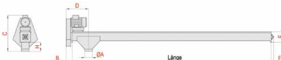
Zwischenauslauf Trogschnecke Ø150 mm
