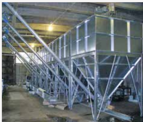
Modulsilos in einer Mahl- & Mischanlage
