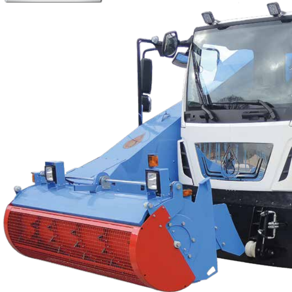
Selbstfahrer SF140S mit Fräse und 3 Schnecken Mischsystem
