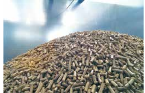
Pelletkühlung im Belüftungssilo
