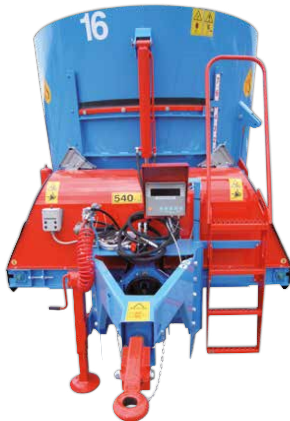
Futtermischwagen VV mit Sonderausstattung Kettenband vorne
