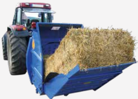
RSM1500 mit Dreipunkthanängung
