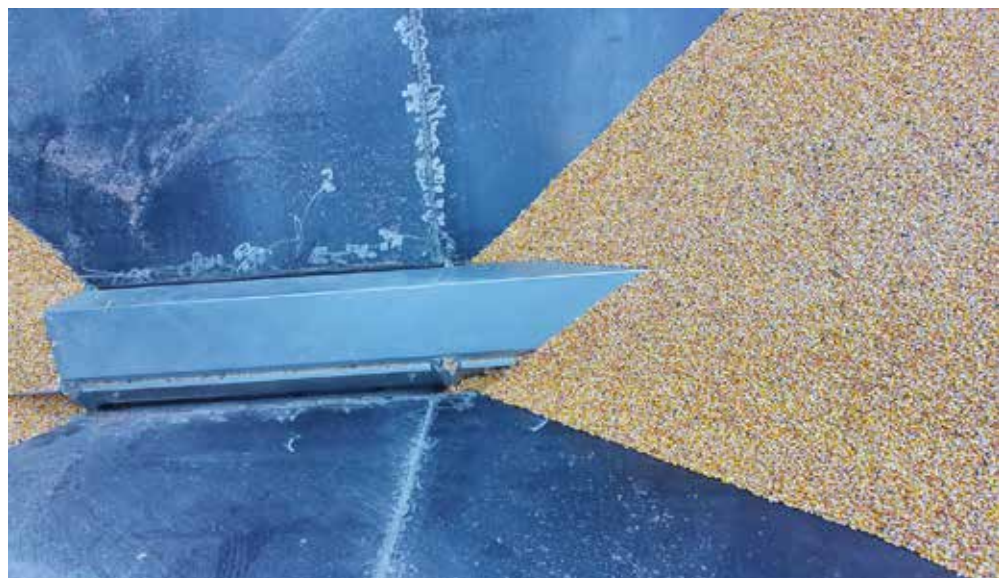
Betonierte Schüttgutannahme mit Gossenredler
