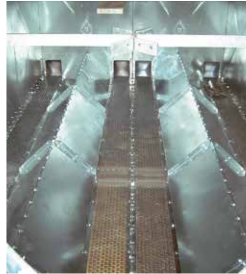
Rechtecklagersilo mit Belüftungsboden
