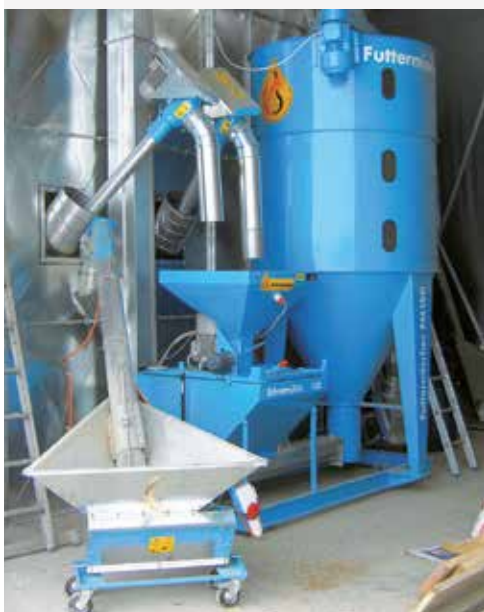
HIMEL Mahl-Mischanlage, Futtermischer FMK 180 mit SC - Mühle
