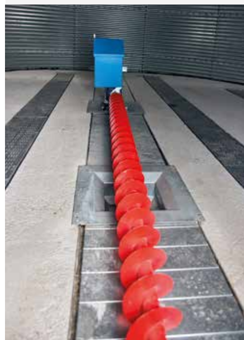
Fegeschnecke im Silo mit Belüftungskanälen
