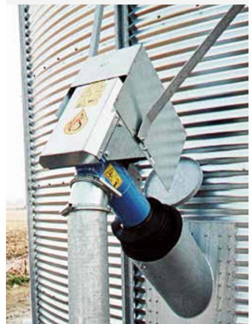
Faltbalg für Abdichtung Entnahmerohr
