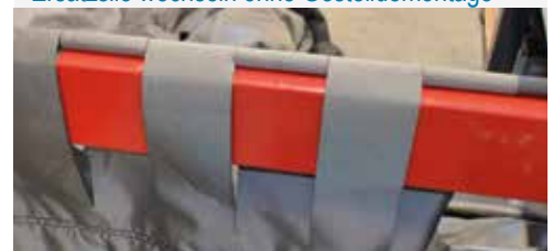
Reparatur durch geteilte Schlaufen
