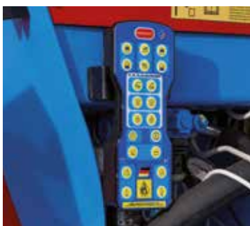
Bedienpult elektromagn. Steuerung
