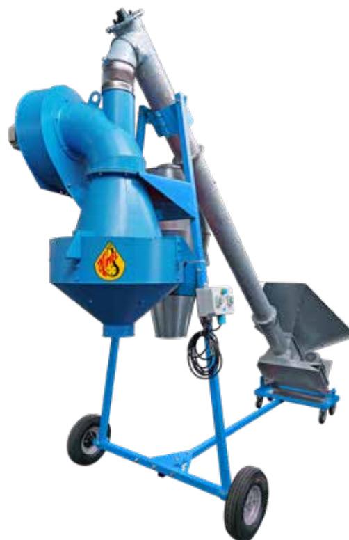
Mobile Abbladestation Ø200 mit Vorreiniger V40
