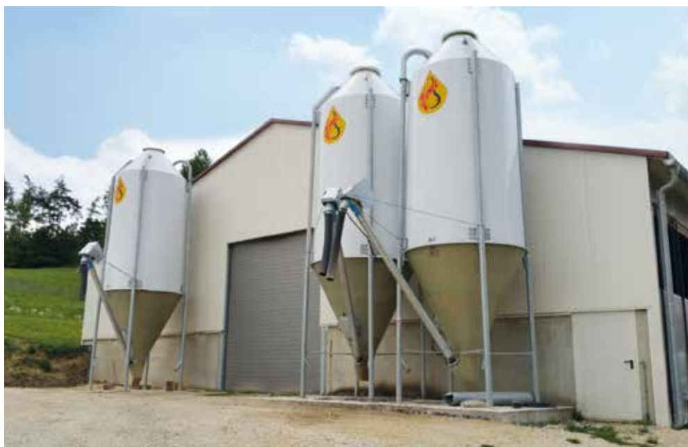
HIMEL GFK Mischfuttersilos mit Förderschnecken
