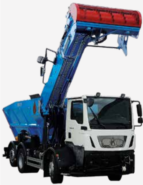
Selbstfahrer SF140S mit Fräse und 3 Schnecken Mischsystem
